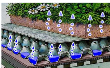
Alvéoles de stockage sous toiture végétalisée. Source : Ecovégétal
